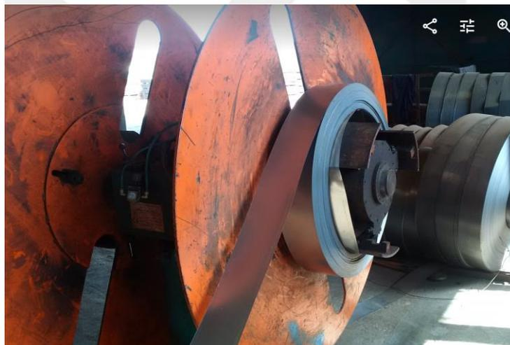
**Aspo Inclinabile** per lo svolgimento della lamiera di larghezza stretta e fine spessore diaetro foro Bobina 380//430mm peso 1Tonn Maxi
