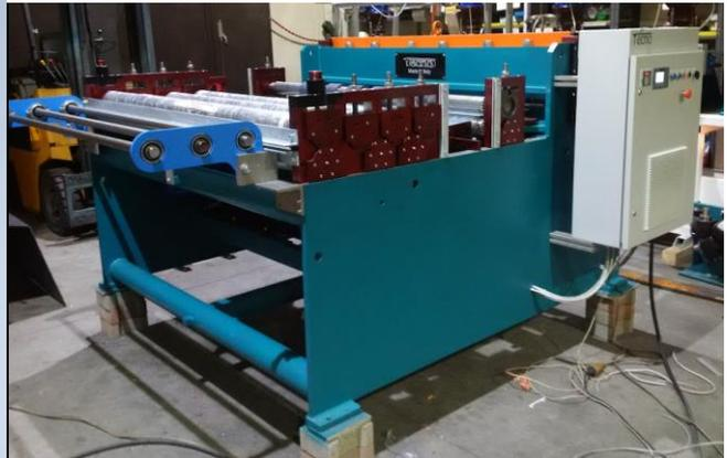
9 rulli di raddrizzatura posteriori realizzati in acciaio legato e nitrurati a spessore diametro dei rulli 90mm connessi meccanicamente tra loro a catena e Motore di traino 10Kw Pinc roll di traino per gli spessori piccoli.
