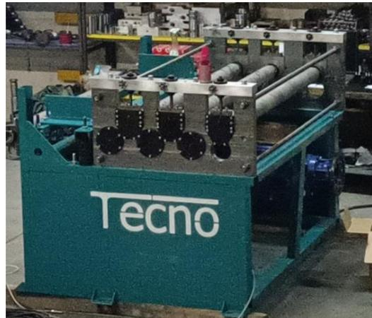
Estremamente robusta i rulli sono connessi attraverso ingranaggi sono motorizzati sia i rulli inferiori che quelli superiori
