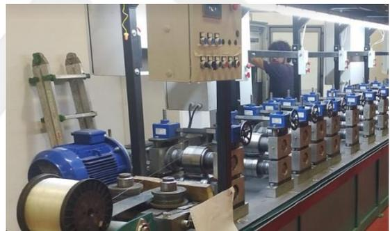
La motorizzazione: a riduttori ortogonali, vite senza fine catena a seconda del profilo che si intende produrre
