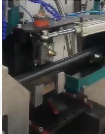
Questo tipo di scordonatore si basa principalmente sulla stabilizzazione che avviene nel tassello di legno inferiore che distribuisce il carico ma ammortizza in modo da non avere vibrazioni sul tubo
