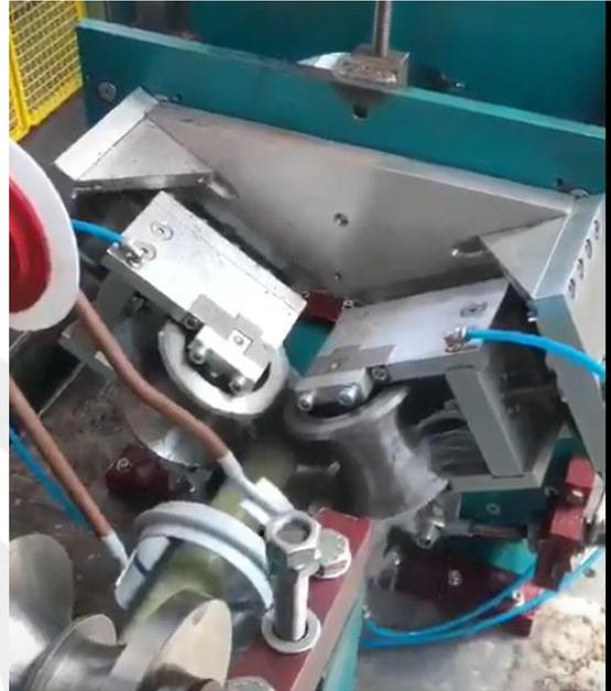
Per migliorare la durata dove si innestano i pattini abbiamo realizzato inserti in acciaio inox i rulli sono chiusi a morsetto .
