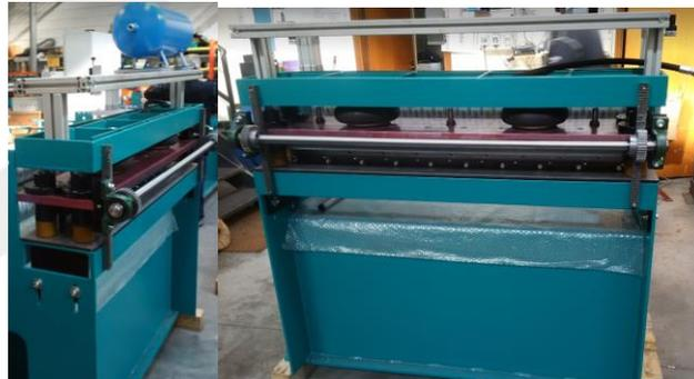
**Cesoia Profili** realizzata su una struttura semplice ma robusta la cesoia profili è composta da un castello robusto e di due lame sagomate all'interno delle quali scorre la lama di taglio .
